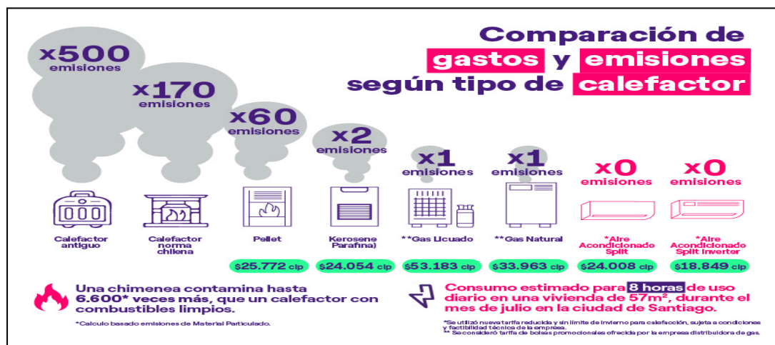
Figura 3 Comparación de gastos y emisiones según tipo de calefactores 2 . Fuente: Enel
