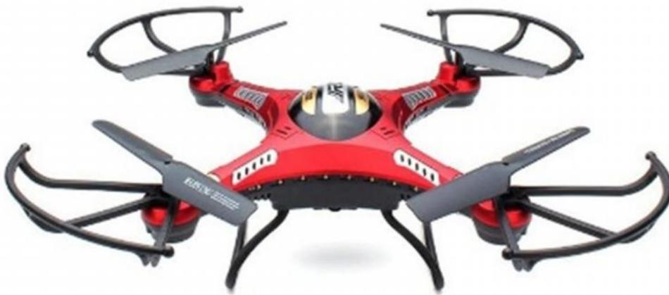
Un dron es una nave pilotada a distancia (RPA, Remotely Piloted Aircraft), es aquella diseñada para operar sin un piloto a bordo, capaz de sustentarse en vuelo pilotada a distancia por medios de control a través de sistemas electrónicos<sup>1</sup>.
